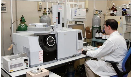
毒物の定性・定量検査を行うためのガスクロマトグラフ質量分析装置 (GC-MS/MS)。充実した研究環境が精度の高い死因究明を可能にしている
